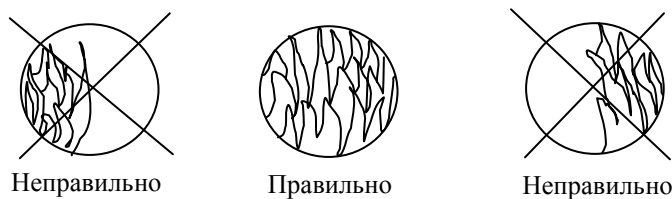
Рис. 4. Расположение датчика относительно пламени и вид на пламя через визирную трубу.
